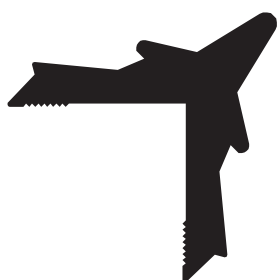
ADR 64 Escuadra de tracción parte interna 0,917 kg/m
