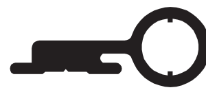
ADR 189 Bisagra de 25 mm 0,557 kg/m
