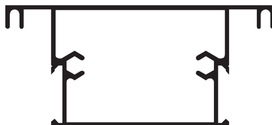
ADR 97 Travesaño puerta de 36 mm 0,803 kg/m
