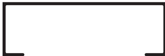
ADR 245 Canal liso 25 x 75 mm 0,526 kg/m
