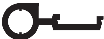
ADR 369 Bisagra Rotonda 700 parte marco 0,629 kg/m
