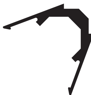
ADR 65 Escuadra de tracción parte externa 0,677 kg/m
